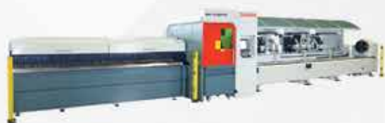
ЛАЗЕРНАЯ РЕЗКА ТРУБ
