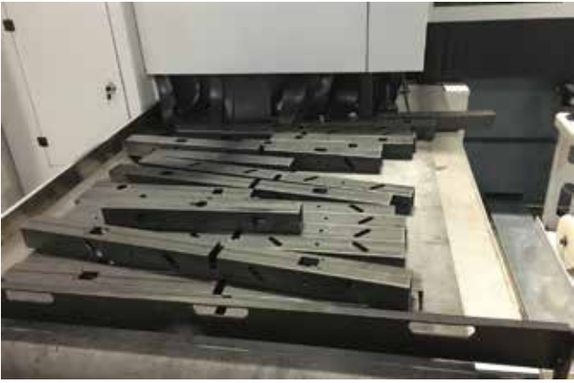
Трубы длиной до 6м снимаются автоматической разгрузочной системой с конвейером
