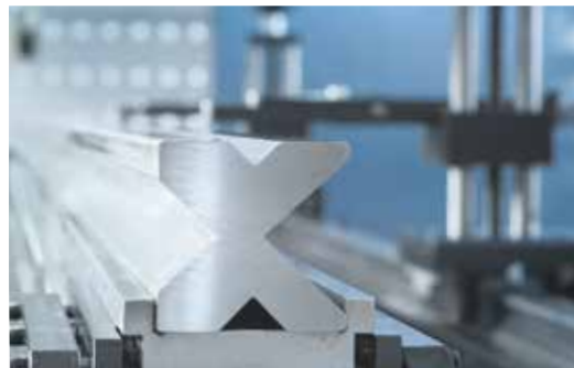
Европейский Тип Нижнего Инструмента (4V Матрица)
