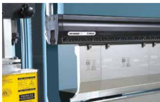
Крепление верхнего инструмента Wila
