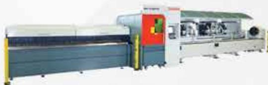
ЛАЗЕРНАЯ РЕЗКА ТРУБ
